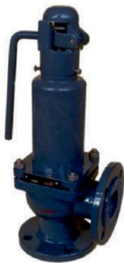
Предохранительные клапаны применяются для установки на резервуарах, котлах, емкостях, сосудах и трубопроводах для защиты от аварийного повышения давления путем автоматического сброса рабочей среды в атмосферу или отводящий трубопровод. После снижения давления до нужного предела предохранительный клапан прекращает сброс среды.
